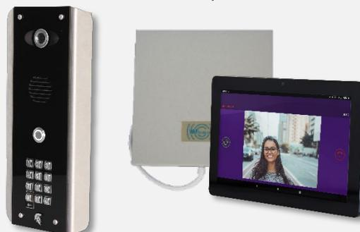
Modèle architectural avec boutons lumineux. Construction en inox marine 316L finition en acrylique. Platine prox: PRAE-IP-PX-FBK
